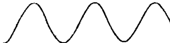
Señal de disparo mediante rechazo de alta frecuencia
