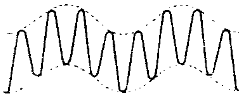
Forma de onda con ruido de baja frecuencia
